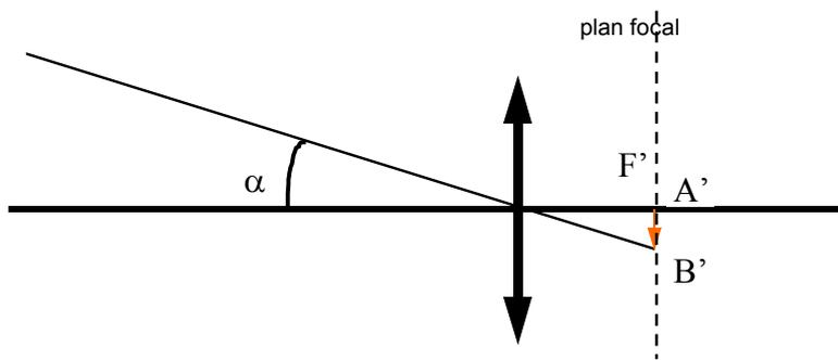
1.) Pour des objets à l'infini, l'image se forme dans le plan focal.
