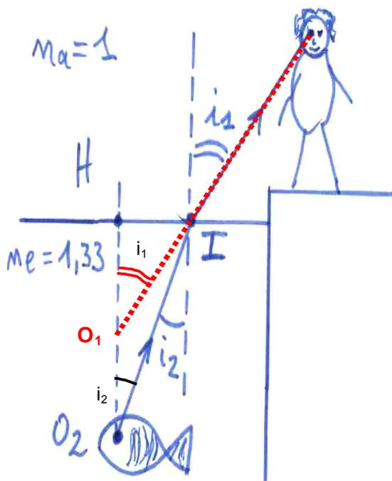
1) Propagation rectiligne : le rayon lumineux entre l'œil de l'observateur et le point I se prolonge et coupe la verticale  $HO_2$  au point  $O_1$
