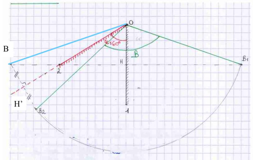
2.3. Quand un miroir tourne d'un angle  $\alpha$  l'image tourne d'un angle  $\beta = 2\alpha$  :
