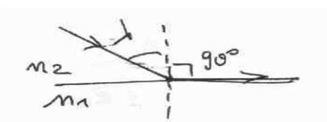
3.2. Si  $i_1 > \lambda$  alors il y a réflexion totale  $\Rightarrow 69^\circ < i_1 < 90^\circ$
