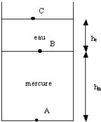
Pour des liquides non miscibles et superposés, il faut écrire la différence de pression pour chaque liquide de façon séparée.
